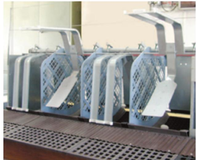
*Abbildung 21. Beispiel eines automatischen Legenestsystems mit Rampen und „Abschiebemechanismus“ (mit freundlicher Genehmigung von MGH)*
